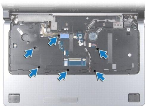
**⚠ ATTENZIONE:** tirare la linguetta in plastica sulla parte superiore dei connettori per evitare di danneggiare i connettori.
